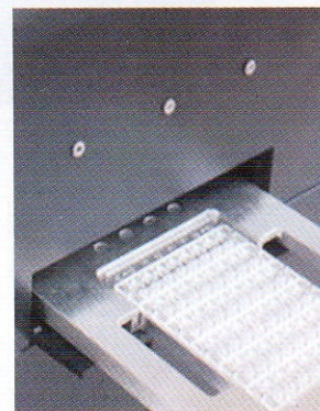
Figuur 6: De microfluidische chip in de DropSense-spectrofotometer van Trinean
